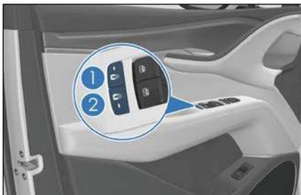
После активации детской блокировки двери автомобиля невозможно открыть изнутри, а переключатель стеклоподъемника соответствующей задней двери нельзя использовать для подъема или опускания стекла. Чтобы отпереть дверь, снова нажмите кнопку детской блокировки для соответствующей стороны или воспользуйтесь наружной ручкой двери.
